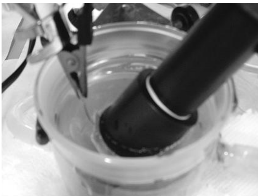
Figura 12. Celda electroquímica de electrodos modificados de un sólo compartimento para la producción de peróxido de hidrógeno.
