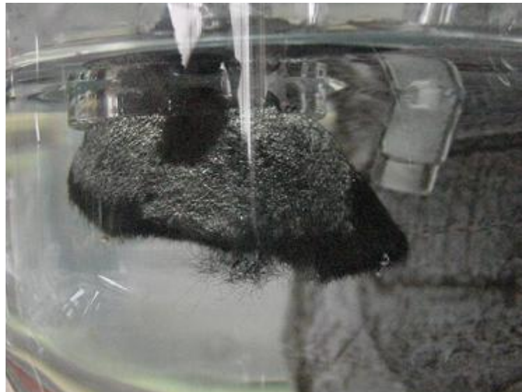
Figura 25. Vista del fieltro de carbono durante la prueba de voltamperometría cíclica.
