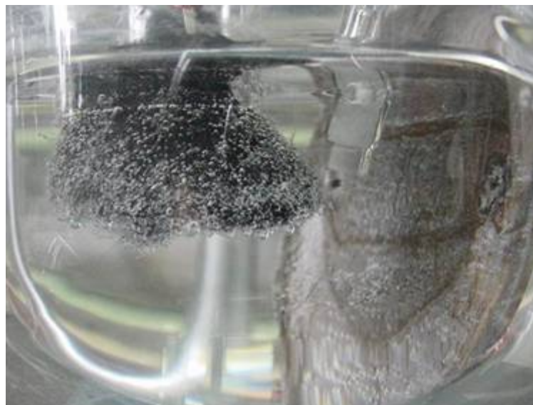
Figura 26. Electrodo del reactor electroquímico durante la prueba de voltamperometría cíclica.
