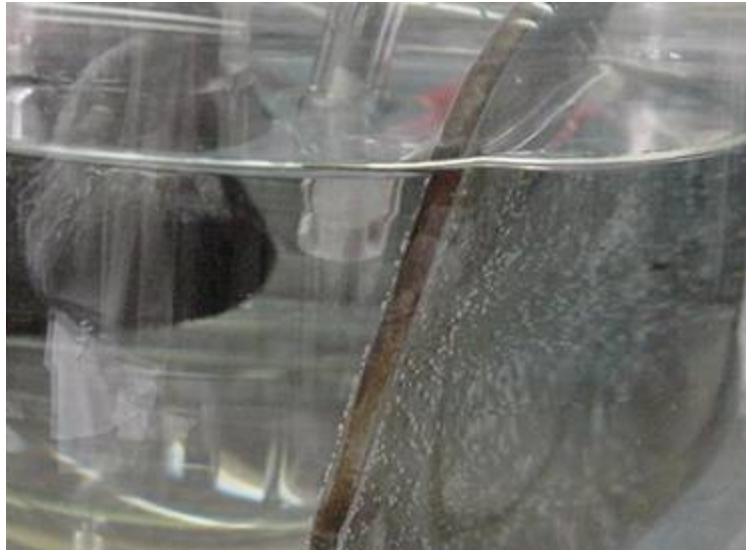
Figura 27. Vista del electrodo de hierro durante la prueba de voltamperometría cíclica.
