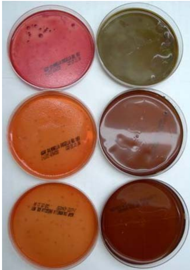
Figura 37. Fotografía de cultivos de E. coli de las aguas residuales antes (columna izquierda) y después de ser tratadas con el reactivo de Fenton electrogenerado (columna derecha).
