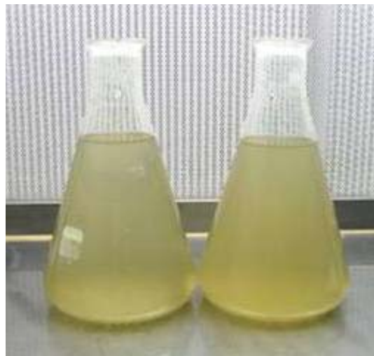
Figura 33. Muestras de agua residual de la PTAR-CU, diferentes concentraciones después del tratamiento con el reactivo de Fenton electrogenerado.
