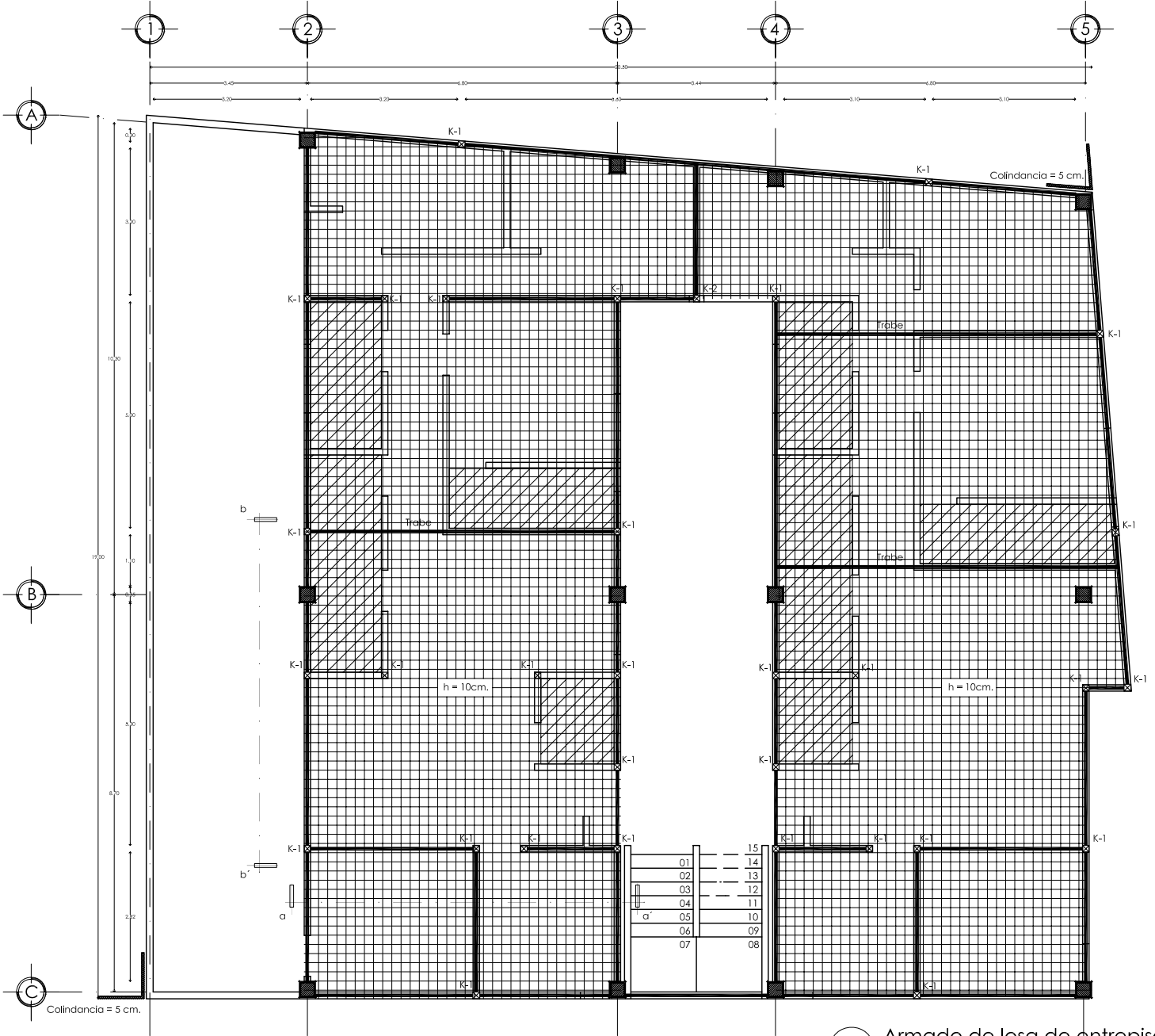
E-05 Armado de losa de entripiso
