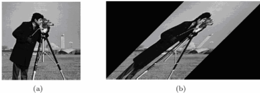
Figura 2.20. Ejemplo de una operación de remuestreo que es usado efectivamente como una operación de rotación para la descomposición con un banco de filtros direccionales DFB. a) La imagen “camera man” b) Imagen “camera man” después del remuestreo.
