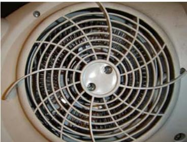
Figura 65: Ventilador para controlar el flujo del aire
