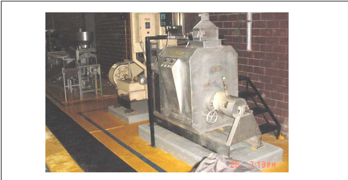
Figura 3.5. Fotografía del extrusor CIATECH de bajo costo (Sánchez-Tovar, 2003)
