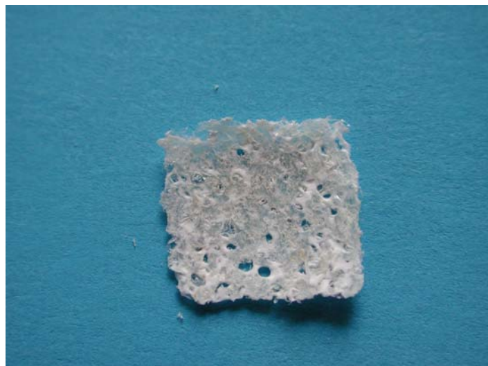
Figura 33. Matrices de colágeno obtenidas por el proceso LEDE en presentación de membranas.
