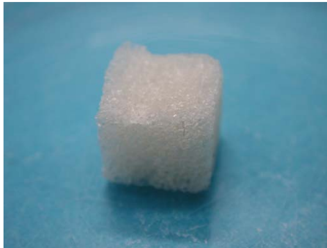
Figura 32. Matrices de colágeno obtenidas por el proceso LEDE en presentación cúbica.
