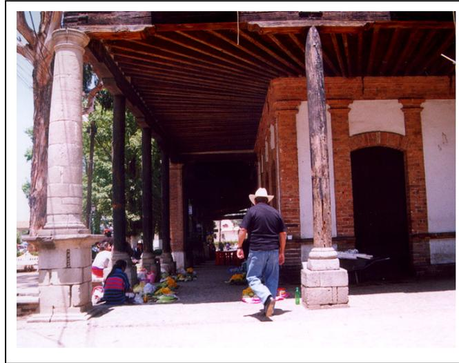
Los pórticos podrán ser de altura sencilla o doble con cubierta inclinada proyectados sobre la vía pública siempre y cuando se tenga un ancho mínimo de banqueta de 1.50 mts y una distancia entre columnas que lo soporten de 4.50 mts como máximo con acabados de vigas de madera que sostengan bóvedas catalanas, enladrillados y cubiertos con teja de barro rojo.
