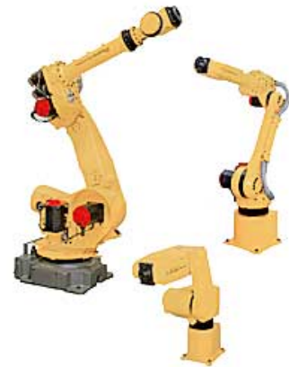
Fig. 3.12 Robot de la Compañía FANUC del tipo punto a punto
