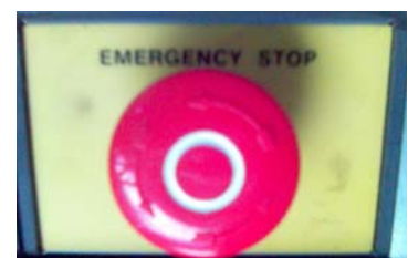
Fig. 5.7 Botón de paro de emergencia del controlador C500C.
