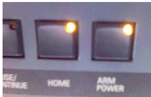
Fig. 6.13 Los led de HOME y ARM POWER deben estar encendidos
