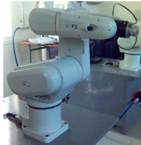
Fig. 6.23 En esta posición el robot se encuentra en HOME
