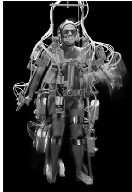
Fig. 3.19 Exoesqueleto capaz de controlar el cuerpo de quien lo viste
