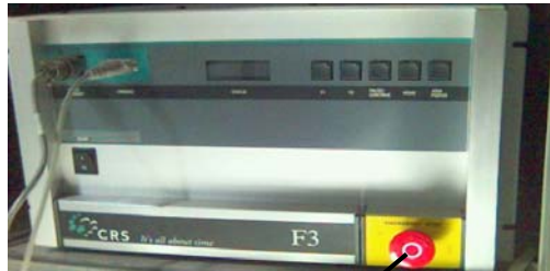
Fig. 6.9 Botón de paro de emergencia del controlador
