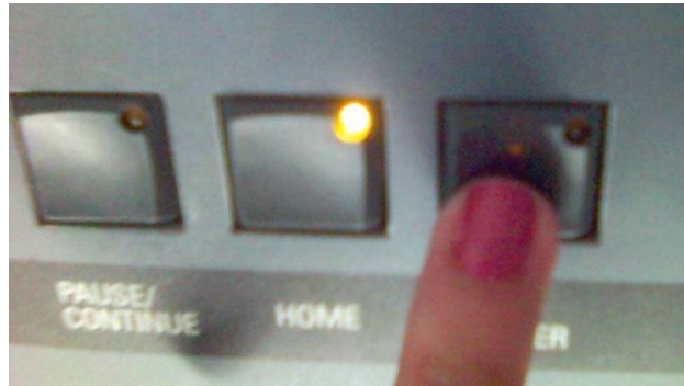
Fig. 6.12 Se presiona el botón ARM POWER, el botón de home esta encendido también.
