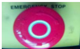
Fig. 6.9 Botón de paro de emergencia del controlador
