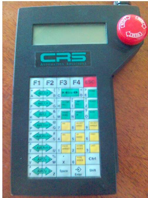
Fig. 6.4 Teach pendant de la marca CRS
