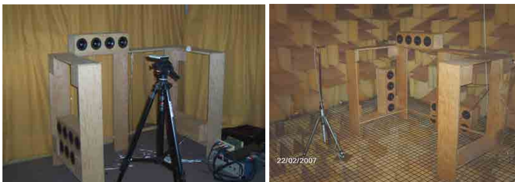
Fig. 4.9. Calibración del arreglo de altavoces en un recinto acústicamente amortiguado (izquierda) y en la cámara anecoica (derecha).
