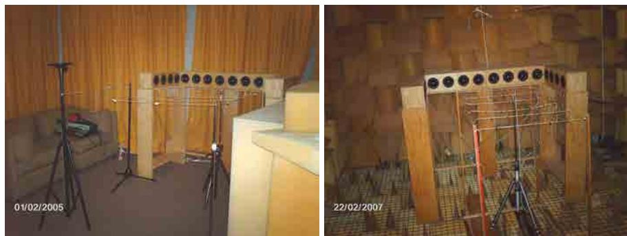
Fig. 4.6. Arreglo instalado en el recinto acústicamente amortiguado (izquierda) y en la cámara anecoica (derecha).
