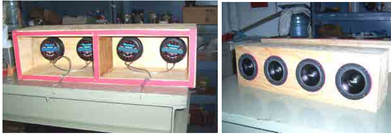
Fig. 4.3. Las bocinas fueron pareadas usando cajas de 4 altavoces, se separó cada canal dentro de la caja para evitar interferencias. Para el sistema se contó con 4 de estas cajas.
