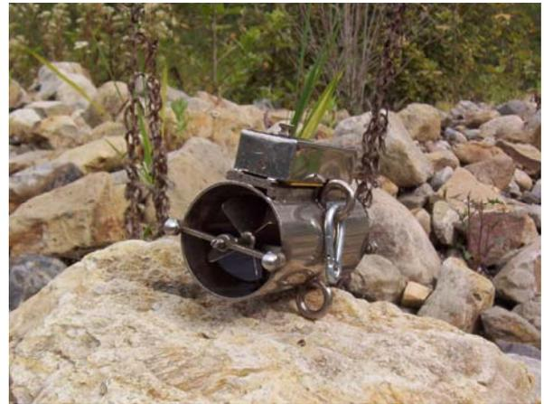
Fig. 8 Correntímetro
