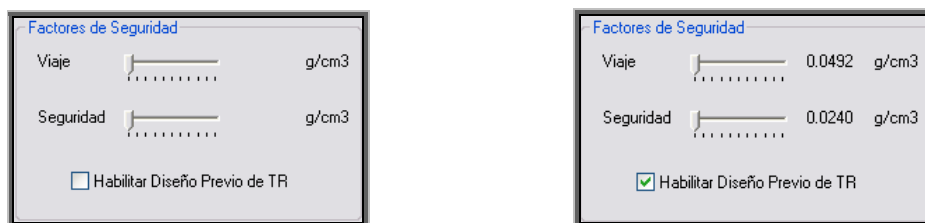
Fig. 2.18 Ventana para habilitar un diseño previo de TR, y modificar los factores de seguridad.
