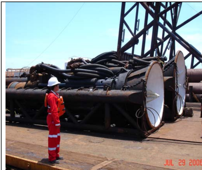
Figura V.4.14. Martillos disponibles en la cubierta del barco instalador.
