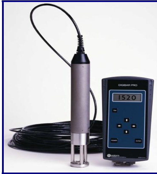
Figura II.1.5. Sistema medidor de la velocidad del sonido en el agua
