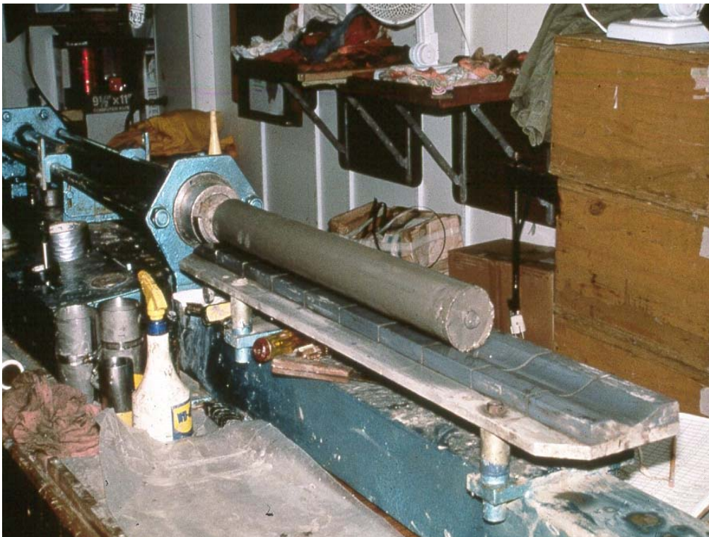
Figura III.2.1 Extracción de las Muestras Inalteradas del Tubo Muestreador
