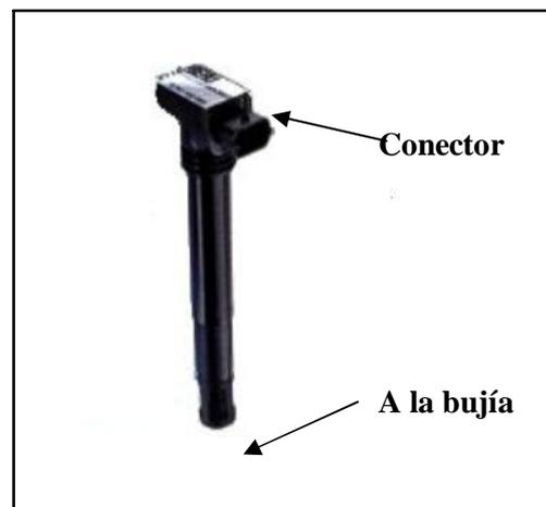
**Fig. 47** *Bobina de ignición individual*
