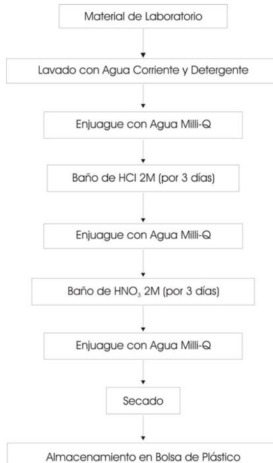
Figura 6. Esquema del procedimiento para lavado de material para el análisis de metales pesados (Moody y Lindstrom, 1977).
