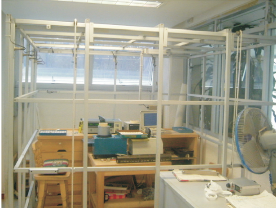
Figura 3.17: Blindaje magnético ambiental. En su interior se encuentra el magnetómetro JR5-A y un mueble de madera para archivar las muestras de estudio.
