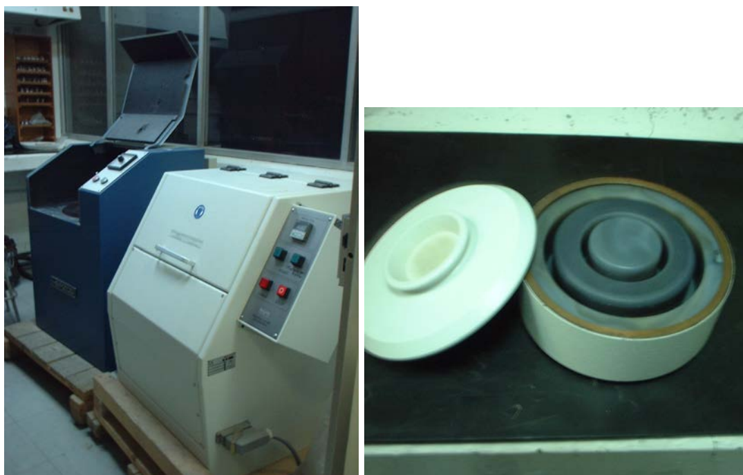
Figura 3.13: Pulverizador eléctrico Fritsch (en color blanco) y el mortero de ágata que usa el pulverizador.
