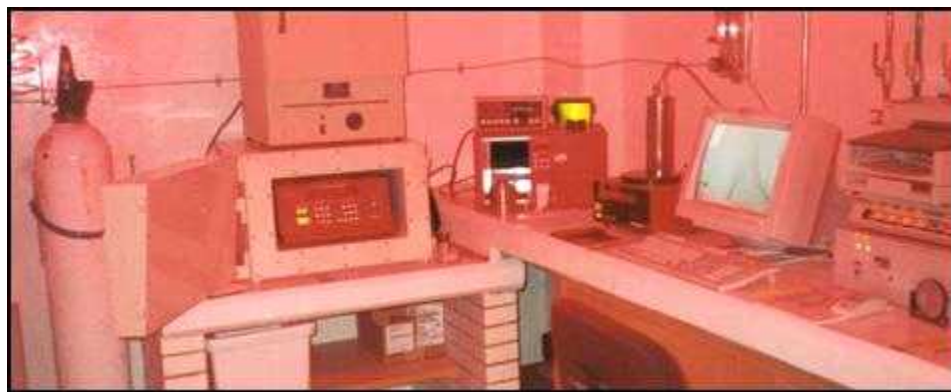
Figura A.8: Vista general del laboratorio de termoluminiscencia. De izquierda a derecha: cilindro de nitrógeno, Irradiador DAYBREAK MULTIPLE SAMPLE IRRADIATOR cubierto por un blindaje de plomo, aparato contador de partículas alfa, lector de termoluminiscencia DAYBREAK 1100 AUTOMATED TL SYSTEM, computadora y graficadora acoplada a lector (derecha).
