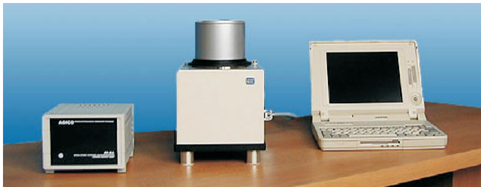
Figura 3.7: Magnetómetro de Giro AGICO JR5-A. De izquierda a derecha: Unidad de medición, unidad sensora y PC .
