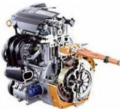
Fig. 1-7 Fotografía del motor del Insight con corte, se puede apreciar el motor eléctrico montado sobre el eje del cigüeñal justo antes del embrague.
