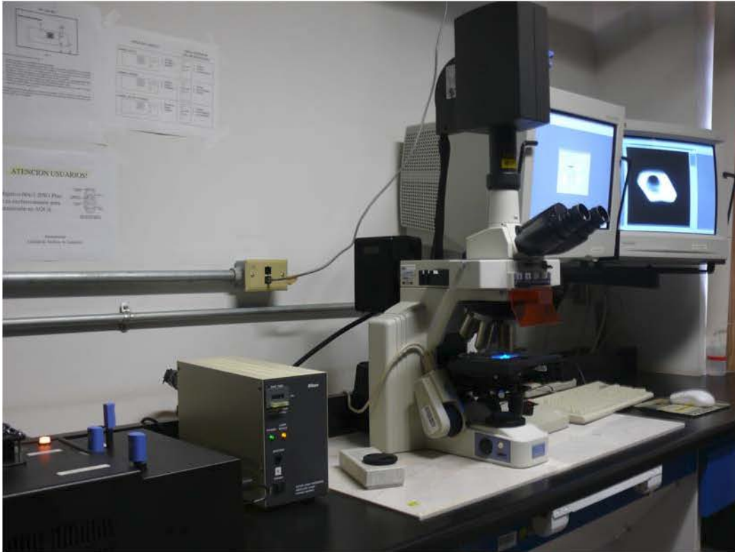
Figura 9.6: Microscopio confocal láser de barrido de la Unidad de Análisis de Imagen Digital en el Instituto de Neurobiología de la UNAM, campus Juriquilla
