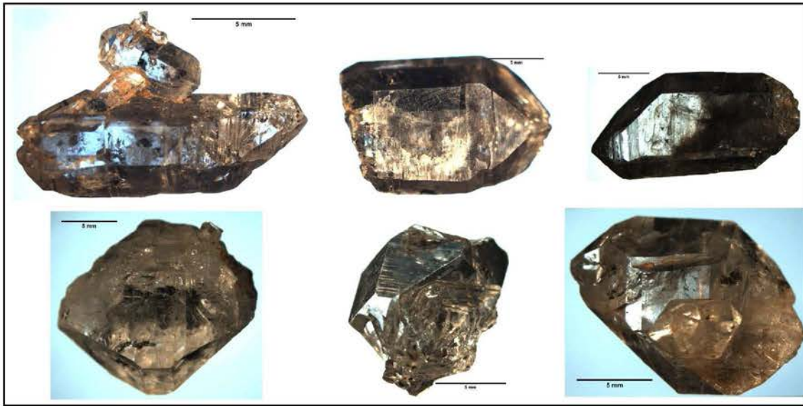
Figura 10.3: Cristales de cuarzo bipiramidales asociados al yacimiento de fluorita de La Cabaña en el distrito minero de Caravia-Berbes, Asturias, España. La barra en las imágenes mide 5mm.
