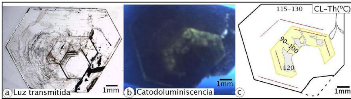
Figura 10.11: Imágenes de una sección paralela al eje cristalográfico c de un cristal de cuarzo. a ) Luz transmitida. b ) Catodoluminiscencia. c ) Esquema de los rasgos visibles en catodoluminiscencia en combinación con las temperaturas de homogenización de las inclusiones fluidas alojadas en las zonas marcadas. Ver texto para más explicación.
