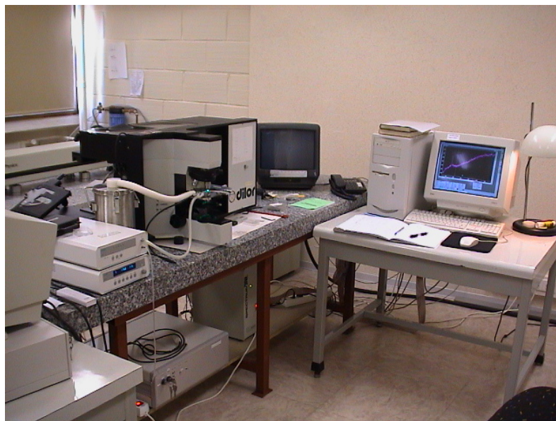
Foto 16. Microsonda Raman (®Dilor-Jobin-Yvon) instalada en el laboratorio CREGU, en Nancy, Francia.
