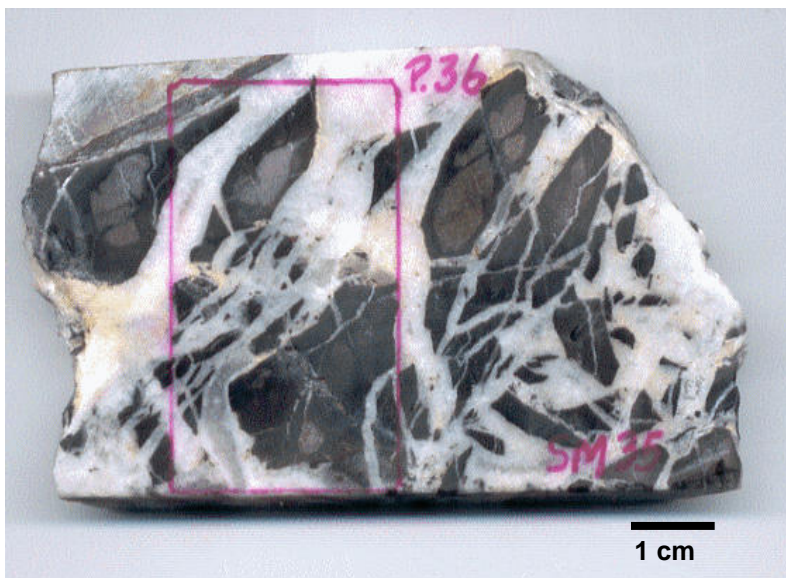
Foto 25. Ejemplar de mano de la muestra SM35. Brecha hidráulica correspondiente a la 1ª etapa. Obsérvese la silicificación en los clastos de caliza y su cementación por cuarzo.
