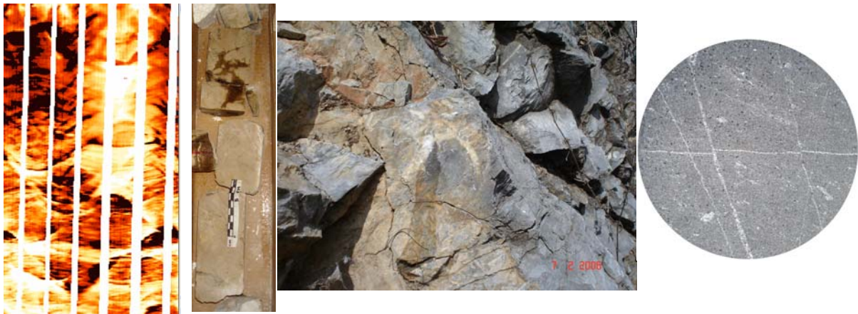
Figura VI.1. Fracturas observadas en registros de imágenes, núcleos convencionales, afloramiento y lámina delgada (de izquierda a derecha). Todos de la Formación Orizaba.
