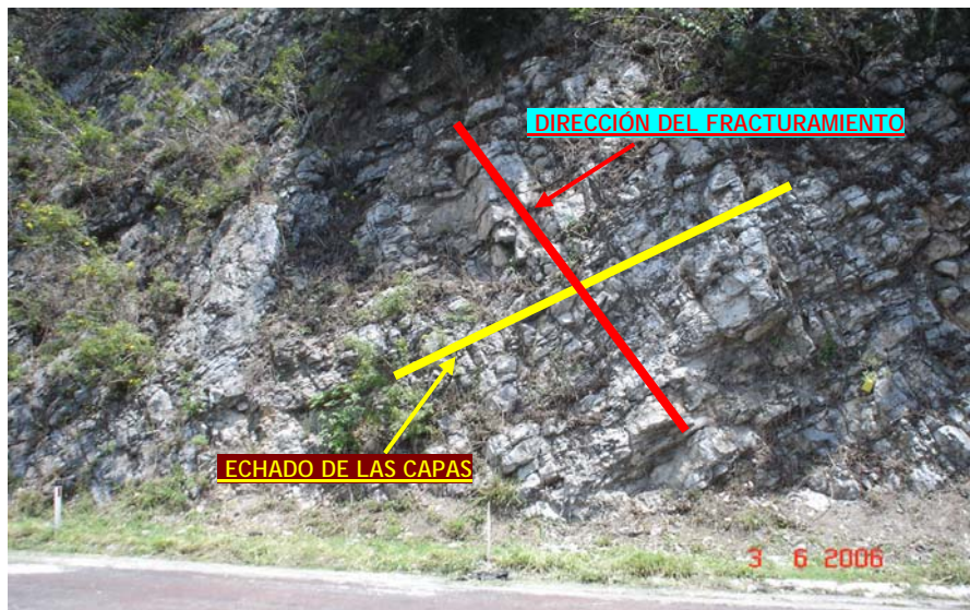
Figura IV.2. Echado de las capas y dirección del fracturamiento del afloramiento en estudio
