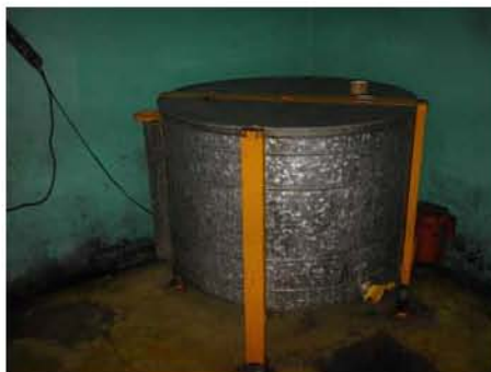
Figura 16. Extractor centrífugo, tipo radial con capacidad de 48 bastidores
