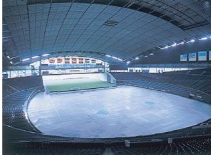
Imagen 2.2.17 Cuando la cancha de fútbol comienza a moverse, la orilla de asientos también comienza a moverse paralelamente con la cancha.
