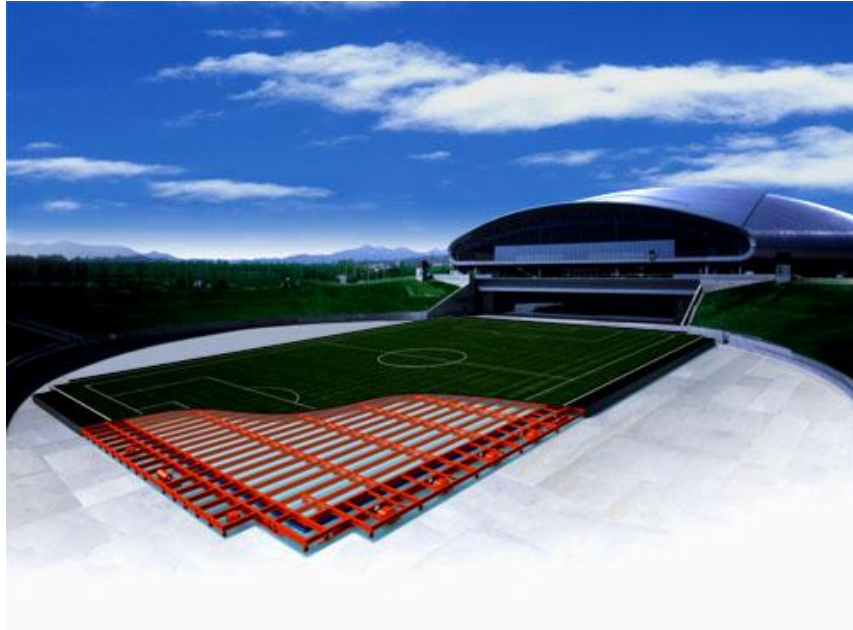
Imagen 2.2.14 Cancha del estadio Sapporo donde se muestra el sistema neumático para desplazarla
