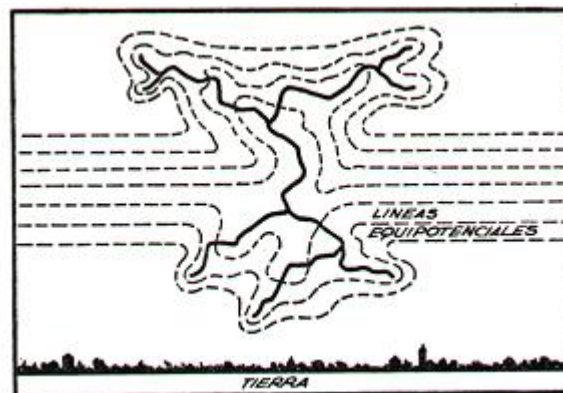
FIGURA 1.16. Descarga en el interior de una nube que no interesa el terreno subyacente y distribución de los potenciales en la atmósfera circundante.
