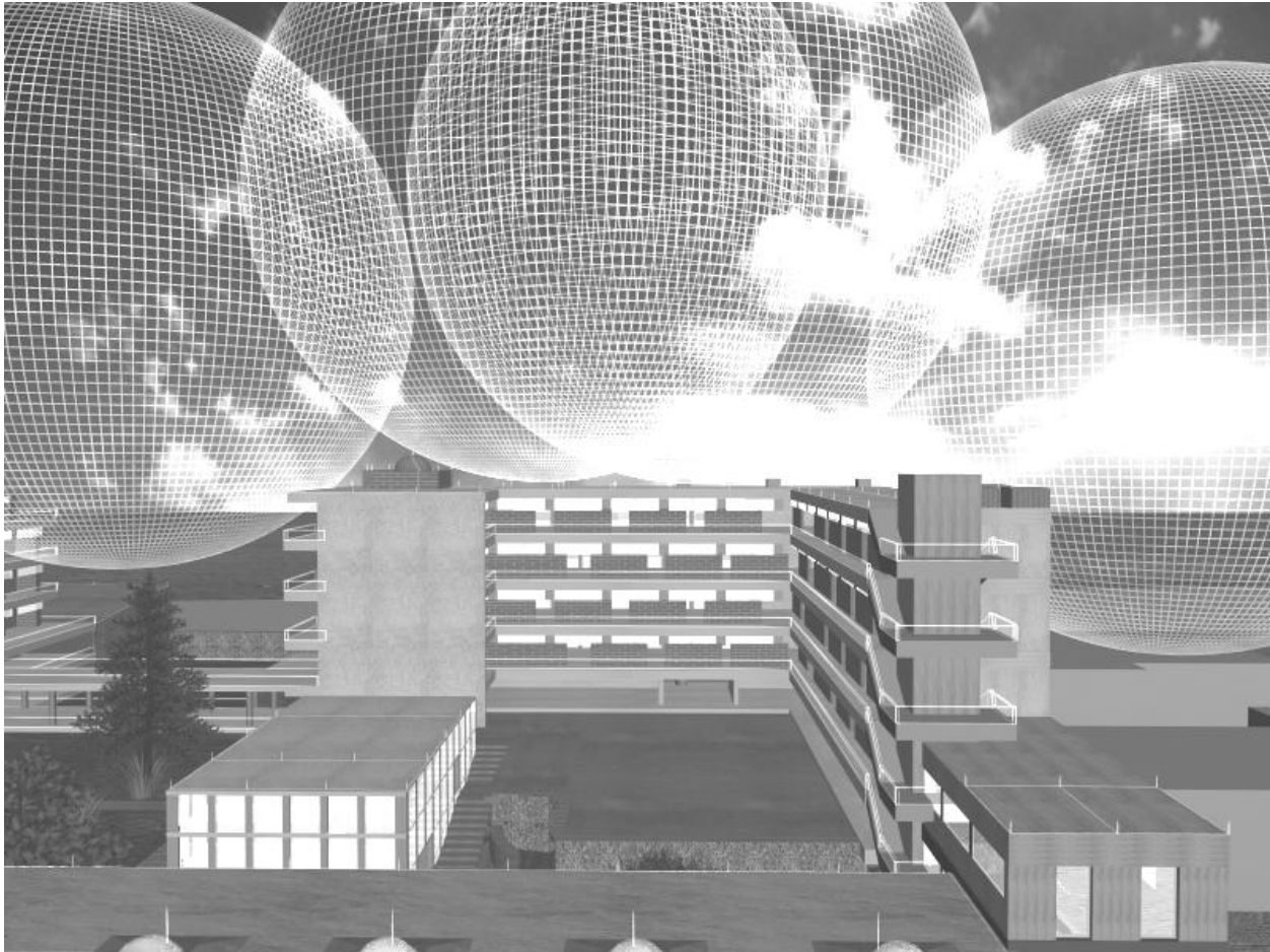
FIGURA 5.7. Rodamiento de la esfera por la estructura a proteger con estructuras vecinas.
