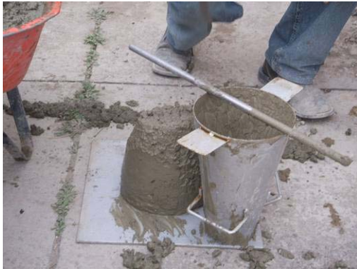
Prueba de revenimiento del concreto utilizado para la cimentación.
