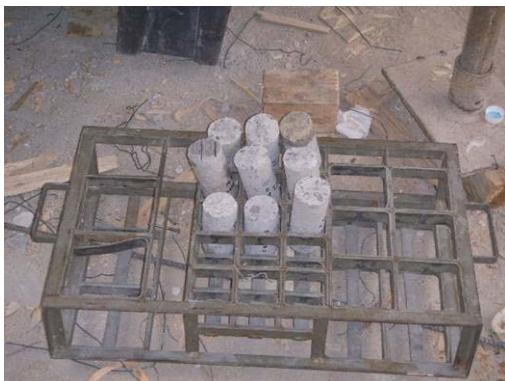
Extracción de los cilindros (corazones) de concreto para las pruebas de resistencia a la compresión.
