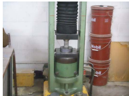
Realización de las pruebas de resistencia que determinarán si el concreto está dentro de los parámetros de las normas. Las pruebas se llevaron a cabo en las instalaciones del AMIC
