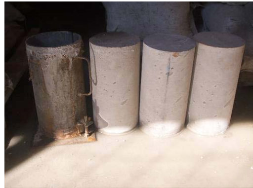
Después se toman las muestras en los cilindros para las pruebas de resistencia que se habrán de realizar en el laboratorio.
