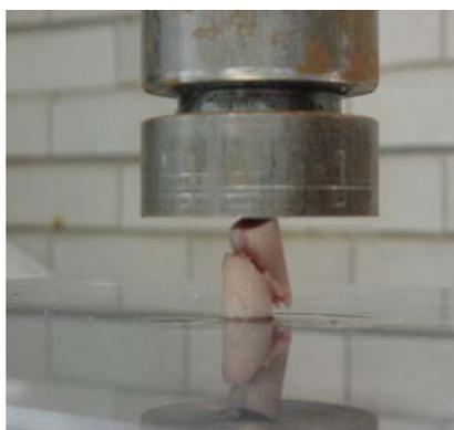
**Fig. 3.5** Ruptura del hueso después de la carga aplicada.
