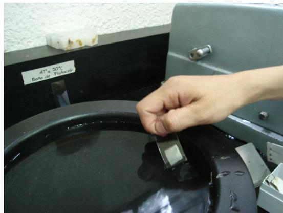
Figura 19. Toma de la muestra del baño de flotación.
