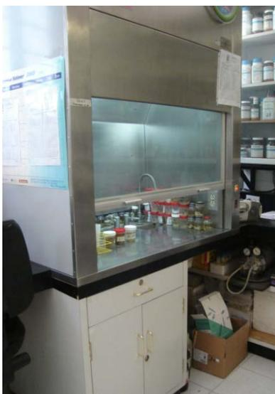
Figura 11. Campana de extracción de gases.
