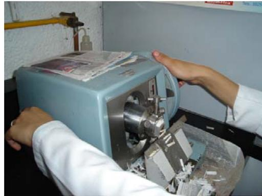
Figura 18. Corte de la muestra en el microtomo.
