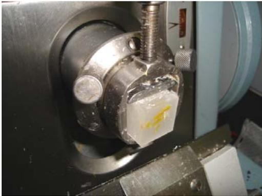
Figura 17. Montaje de la muestra en el microtomo.
