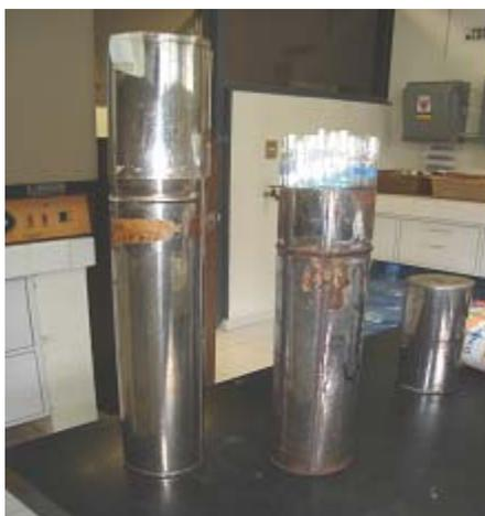
Figura 4. Preparación de pipetas para ser esterilizadas.
