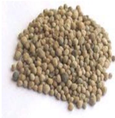
Fig. P Material relleno empleado en el biofiltro
