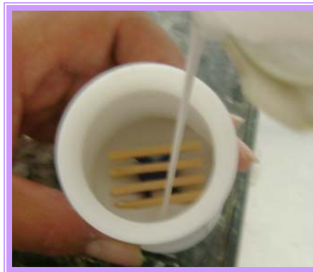
Fig. 14. Rellenado del cilindro con el revestimiento
