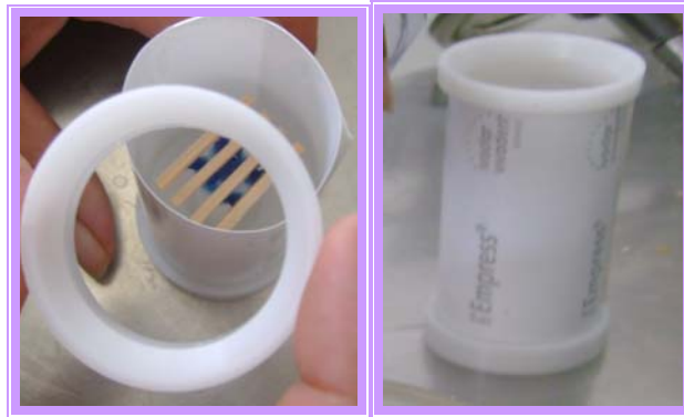
Fig. 11. Colocación del cilindro de papel sobre la base del cilindro y colocación del aro de estabilización
