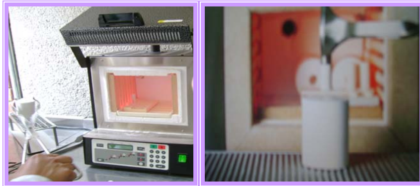
Fig. 17. Extracción del cilindro del horno e introducción del pistón en el cilindro después de haber colocado la pastilla
