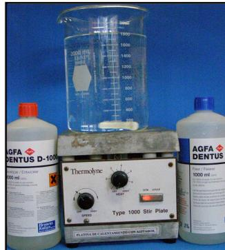
Figura 14. Parrilla eléctrica con agitador, se agitó primero el fijador y posteriormente el revelador AGFA
