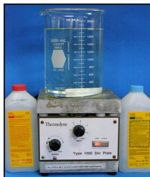
Figura 13. Parilla eléctrica con agitador, se agitó primero el fijador y posteriormente el revelador Kodak
