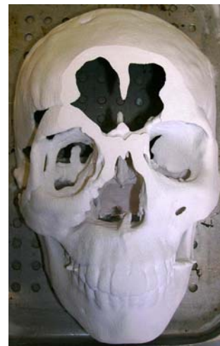
Foto 2. Estereolitografía (fuente directa).
