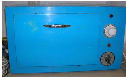
Foto 49. Horno de calor seco (fuente directa).
