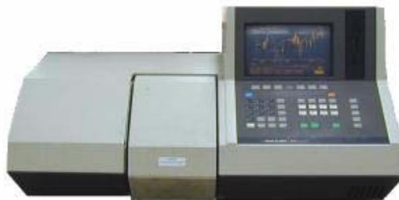
**Figura 4.3** Equipo FTIR Perkin Elmer 1600, ATR (ZnSe).
