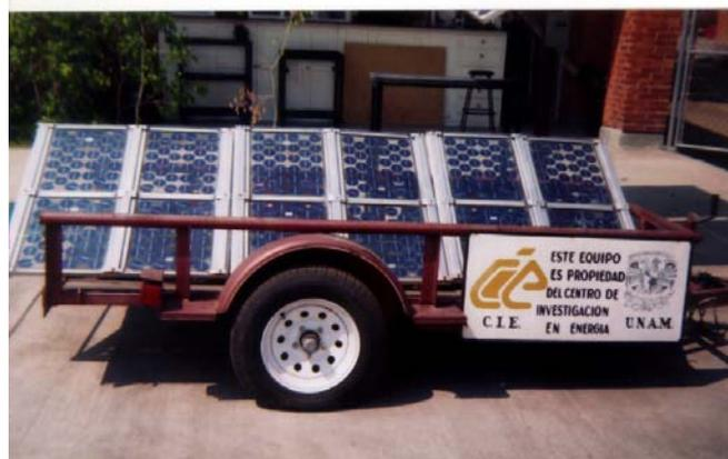
Imagen 3.12 Páneles fotovoltaicos de silicio monocristalino
