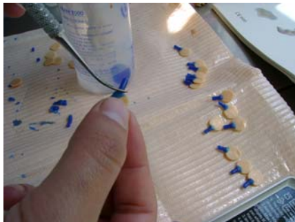
fig. 2 colocando cueles a las muestras de cera Proart. (fuente directa)
