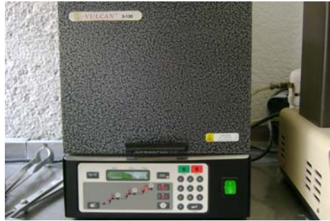
Fig.6 Horno para desencerrar (fuente directa)
