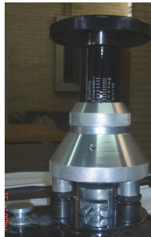
**Figura 13. Medidor de pruebas para adherencia por arranque Elcometer 106**
