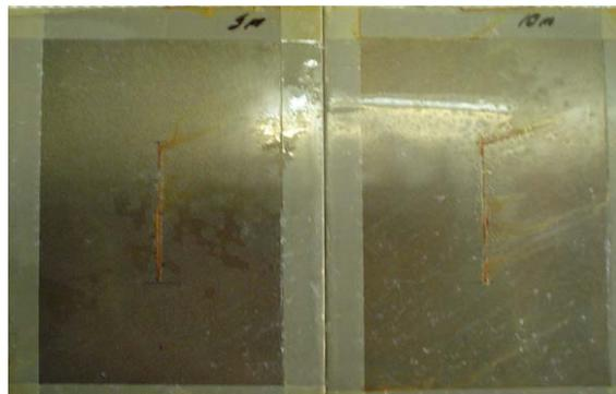
Figura 27: Aspecto físico de las muestras del PCh a 5 min después de evaluar en cámara de niebla salina durante 520 hrs. de exposición.
