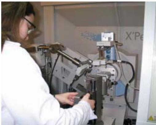
**Figura 6. Equipo de difracción de rayos X**
