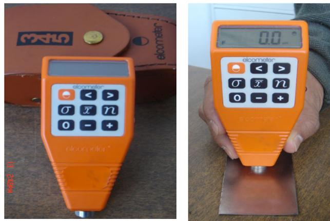
**Figura 12. Medidor de espesores Elcometer 345.**
