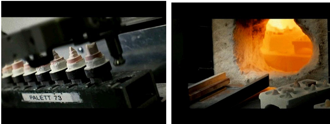
Fig. 26. Duplicado de las preparaciones y proceso de sinterizado. (18)
