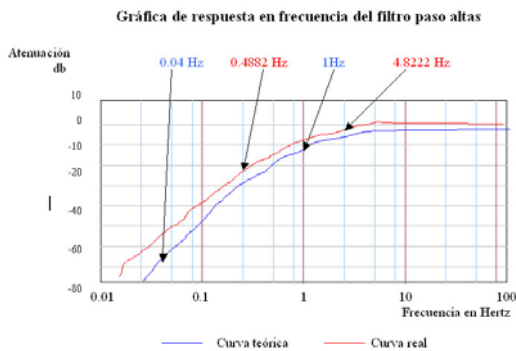
Gráfica no 8. El filtro paso altas, contiene dos señales de oscilación (< 0.04 Hz) y (1 Hz), el filtro bloquea la señal antes de amplificar y de oscilar.
