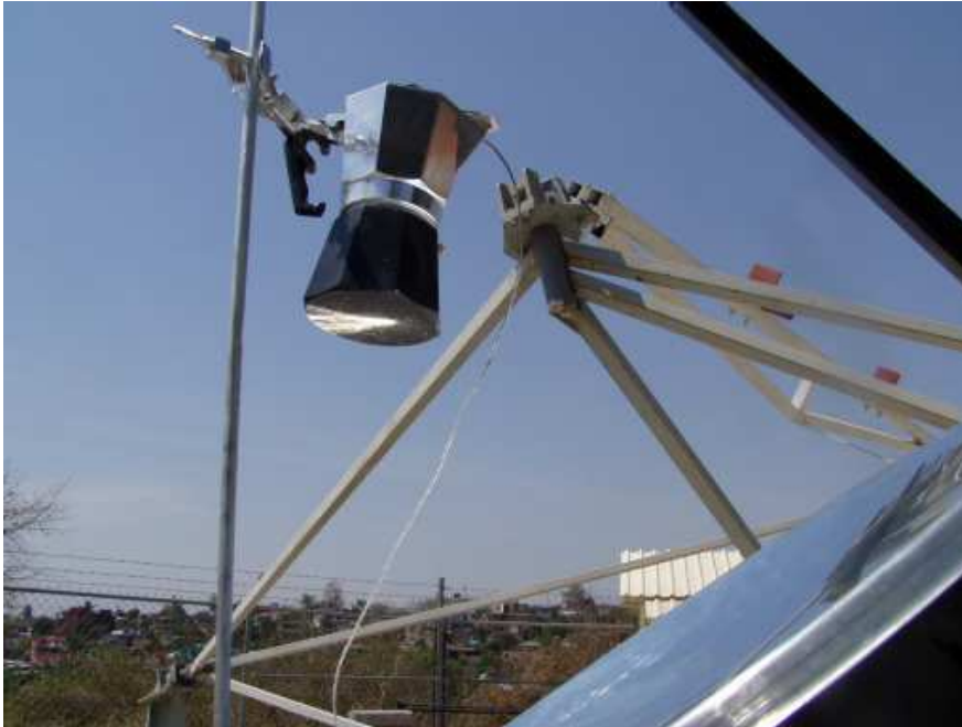
Figura 3.9: Ilustración de la deformación del foco sobre la Cafetera Espresso .
