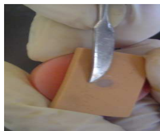
figura 12 quitando exceso del cemento
