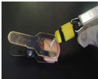
figura 11 muestra sujeta aplicando el cemento
