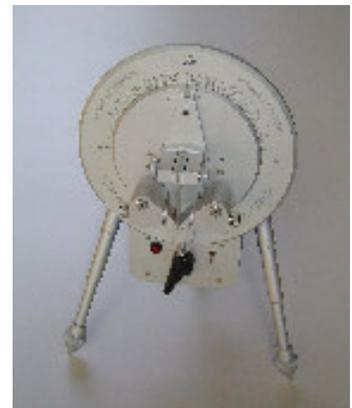
**Imagen 45** Máquina utilizada para medir la rigidez del cartón
