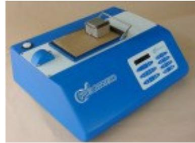
**Imagen 43** Máquina para probar la resistencia al rasgado del cartón
