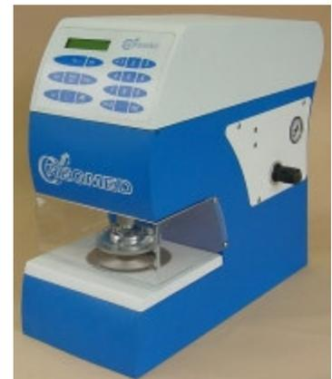
**Imagen 42** Máquina para probar el nivel de explosión al deformar el cartón
