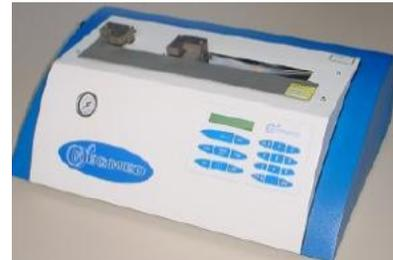
**Imagen 44** Máquina para medir el nivel de carga de un cartón al ser sometido a tensión a lo ancho del mismo
