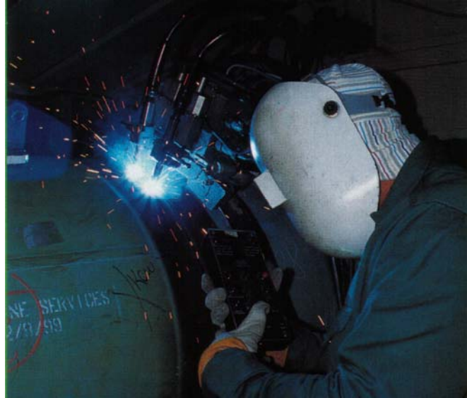
Ilustración 1.10- El soldador utiliza el control para ajustar la distancia de la boquilla a la pieza de trabajo, la velocidad de avance y el ancho de la oscilación
