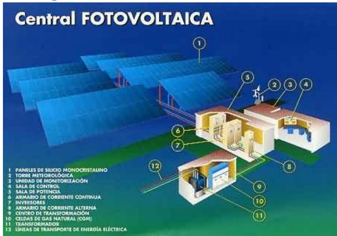
Figura 11. Imagen que ejemplifica el funcionamiento de una central fotovoltaica. Elaborada por vazparfotos. Encontrada en la página web: [vazparfotos.tripod.com](http://vazparfotos.tripod.com). 2006
