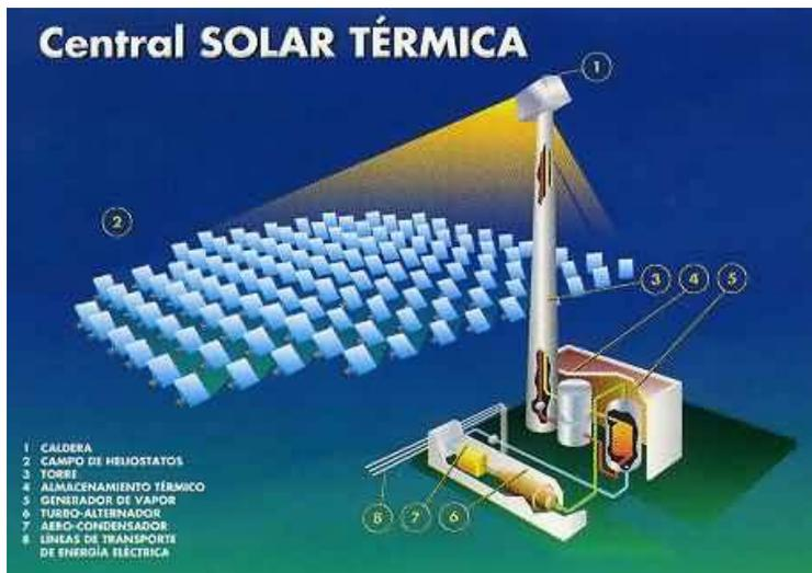
Figura 10. Imagen que ejemplifica el funcionamiento de una central solar térmica. Elaborada por vazparfotos. Encontrada en la página web: vazparfotos.tripod.com. 2006
