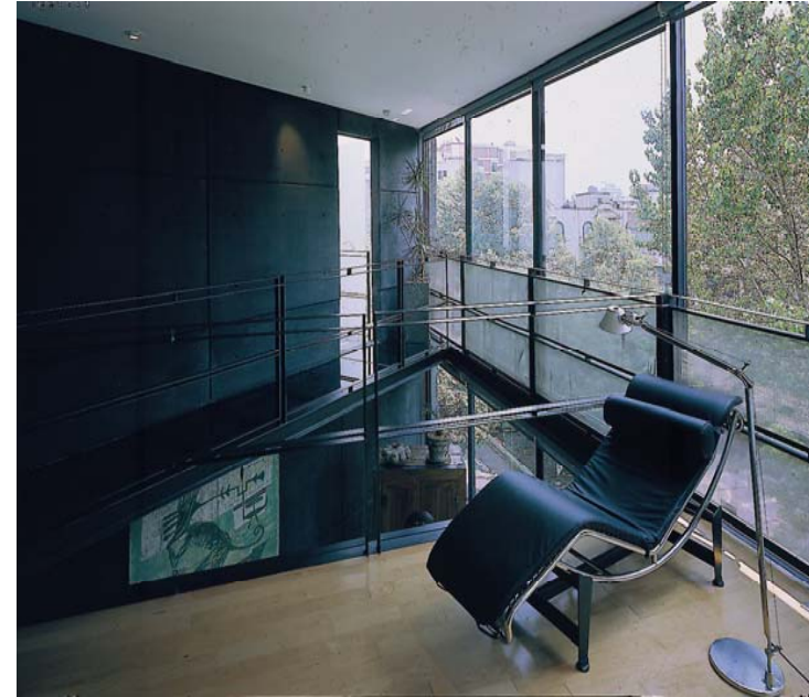
La privacidad en la “vitrina” se resuelve con materiales que filtran las vistas del exterior, como la malla de los barandales.
