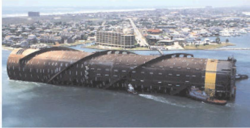
**Figura II.7** Casco listo para ser remolcado.
