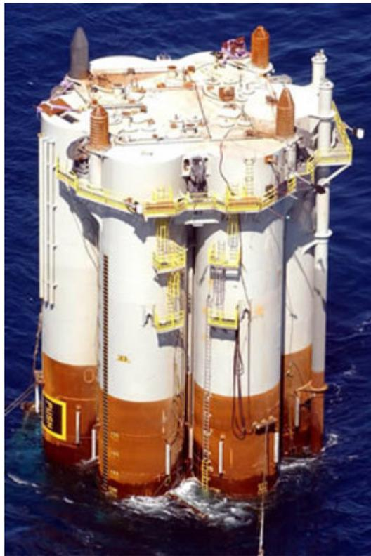
**Figura II.4** Casco de flotación de una plataforma tipo Spar Cell
