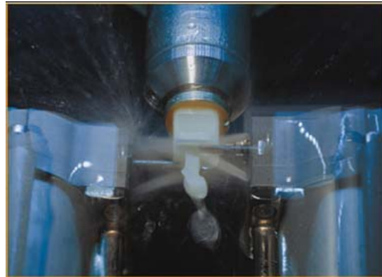
Fig. 3. 3 Cámara de fresado CEREC 3 con la presencia de dos fresas 14 .
