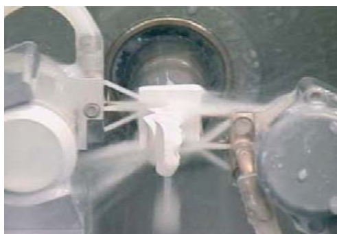
Fig. 3.5 Cámara de fresado Sirona in Lab para ZirCAD 36
