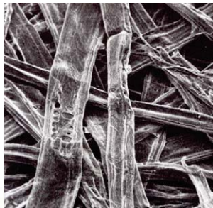
Fig. 166. Misma fibra de madera hinchada y vista a 110 aumentos (modificación en la estructura de las fibras).
