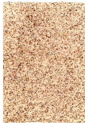
Fig. 307. Hoja hecha a mano con hoja de cedro y pulpa de papel.
