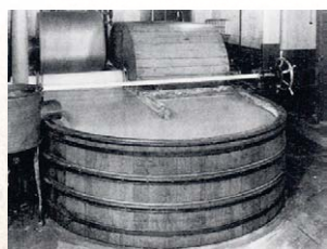
Fig. 33. La holandesa moderna con materia procesada.
