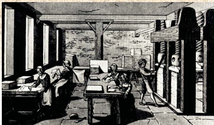
Fig. 29. Ilustración. Parte de un taller donde se elaboraba el papel hecho a mano (de tina o cuba).
