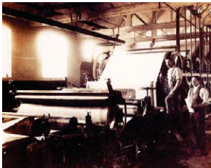
Fig. 43. Máquina llamada fourdrinier para hacer papel en forma continua hecha en Inglaterra, 1803.
