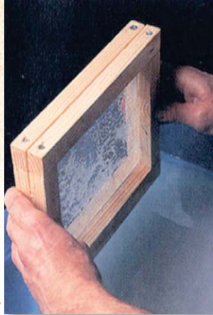
Fig. 682. Posición del bastidor en la tina o recipiente con la pulpa o fibra.
