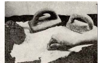
Fig. 25. Planchas de piedra para el afinado y pulido de la hoja de papel.
