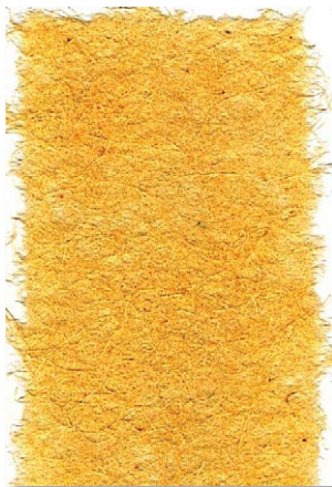
Fig. 525. Hoja hecha a mano con la fibra blanqueada del tallo de plátano.
