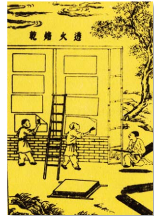
Fig. 7. Otra manera de poner a secar las hojas de papel.
