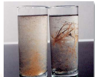
Fig. 192. Forma de revisar que la fibra este abierta o separada (un vaso con agua).
