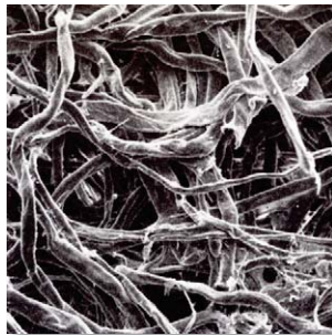
Fig. 164. Fibras de algodón vistas a 130 aumentos.
