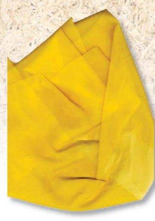
Fig. 122. Malla sintética poliester (para serigrafía T-63).
