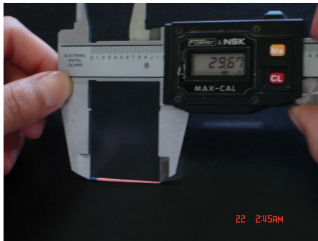
Medición de una punta con vernier
