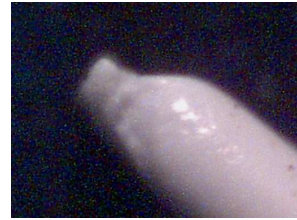
Fotografía tomada con el Microscopio Intel play de Una punta # 15 Dentsply A 200x
