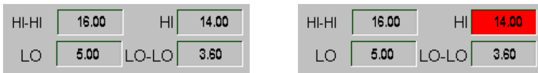
Fig.2.31 Indicador en estado de operación normal Fig.2.32 Indicador con nivel de alarma HI rebasado.
