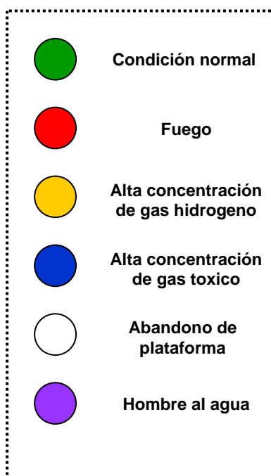
Fig. 1.1 Alarma Visible (Semáforo).
