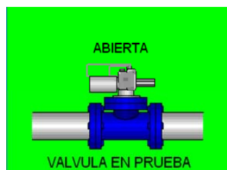
Fig.2.30 Válvula en prueba parcial fondo verde.
