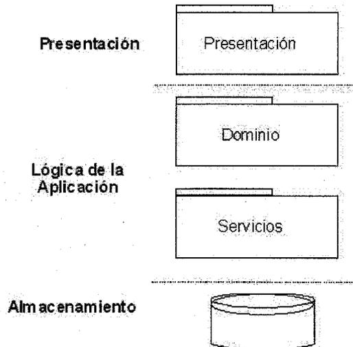
Fig. 34 Arquitectura de un sistema utilizando paquetes.
