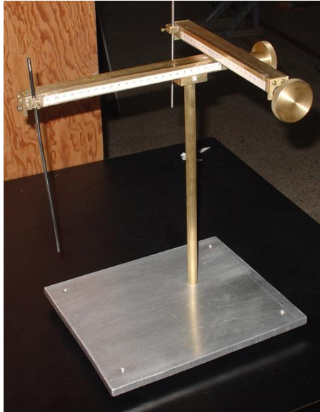
Figura 4.4.4. Sistema de desplazamiento en dos dimensiones.
