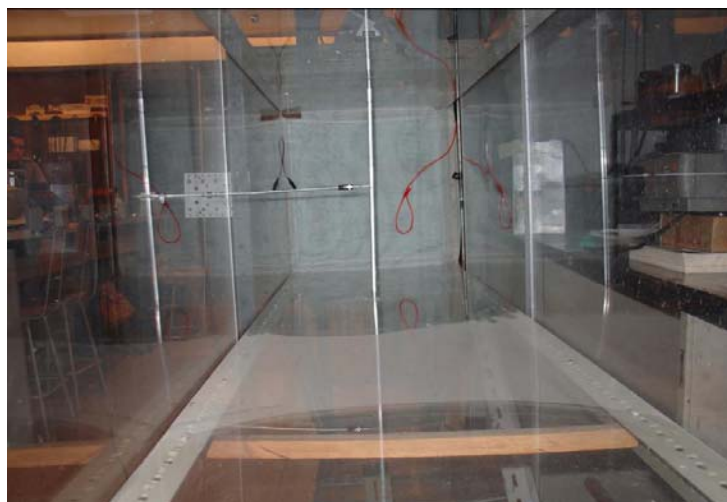
Figura 4.3.2. Vista al interior del túnel de viento con sonda en la zona central de la calle de vórtices de von Kármán.
