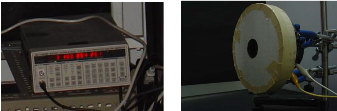
Figura 4.1.2. A la izquierda el generador de señales Stanford, a la derecha, la bocina generadora de vórtices anulares.
