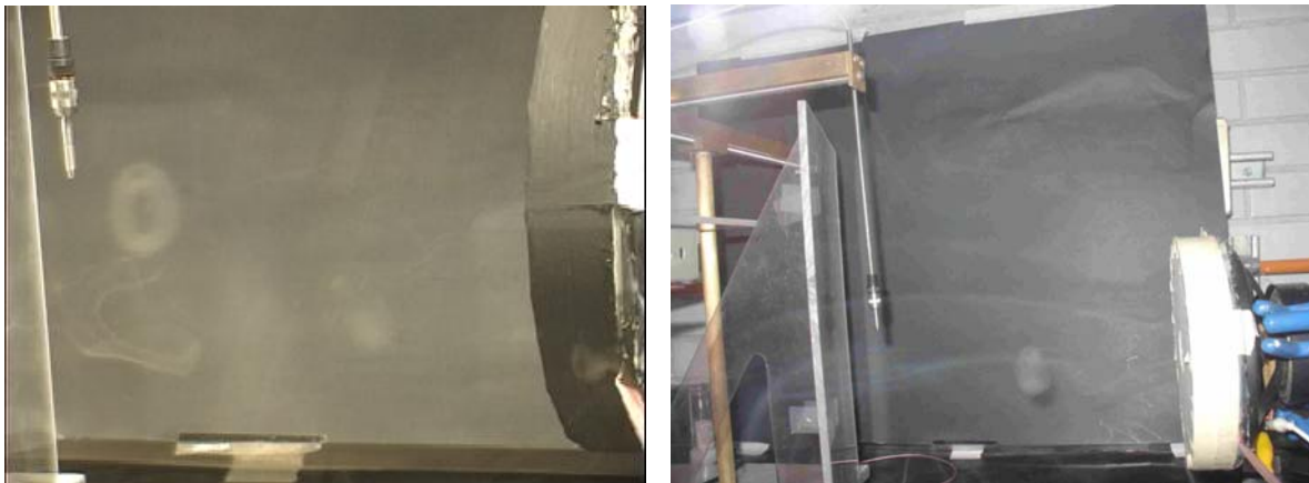
Figura 4.4.7. Vista lateral de vórtices anulares antes de interactuar con la pared.
