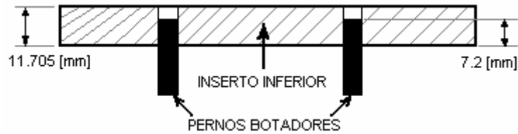
Figura 3.18 Ubicación del perno botador a partir de la base del inserto inferior
