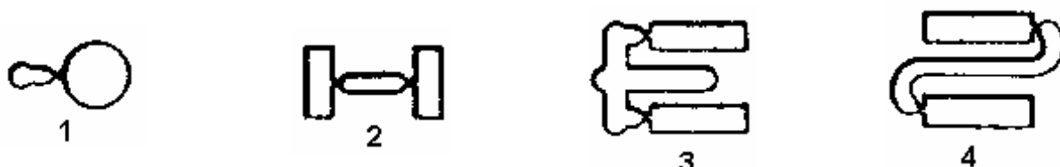
Figura 2.40 1) Colada para una cavidad, 2) Colada y dos cavidades, 3) Colada y dos cavidades tipo T, 4) Colada y dos cavidades tipo S
