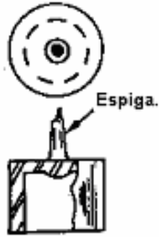
Figura 2.26 Diagrama de punto de inyección tipo espiga
