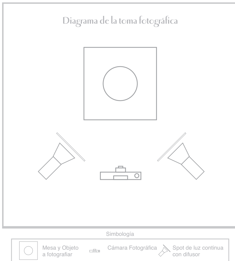
FIG. 3.41. Esquema básico de fotografía para las sesiones del Campanario Café. Teniendo como variantes, el uso de un spot (cambiando su ubicación); Así como la altura de la cámara fotográfica.
