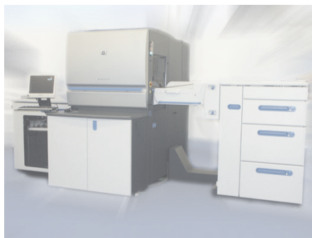
FIG. 2.30. Imagen de la máquina HP-Indigo Press 5,000 –modelo de 7 colores-. Expuesta en Imprexpo 2005, Guadalajara.
